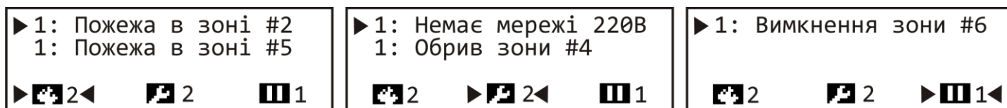
Рисунок 21 – Приклад активних полів дисплея (Пожежа, Несправність, Вимкнення).
