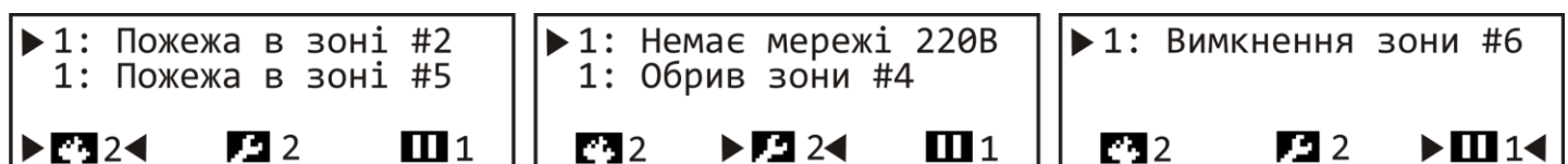
Рисунок 6 – Приклад активних полів дисплея (Пожежа, Несправність, Вимкнення).
